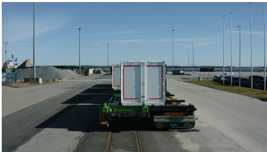
Figur 2 Safe Green Logistics løsning på at udveksle containere mellem lastbil og tog
